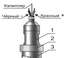
Рисунок 5 - Вид электрического присоединения РК
